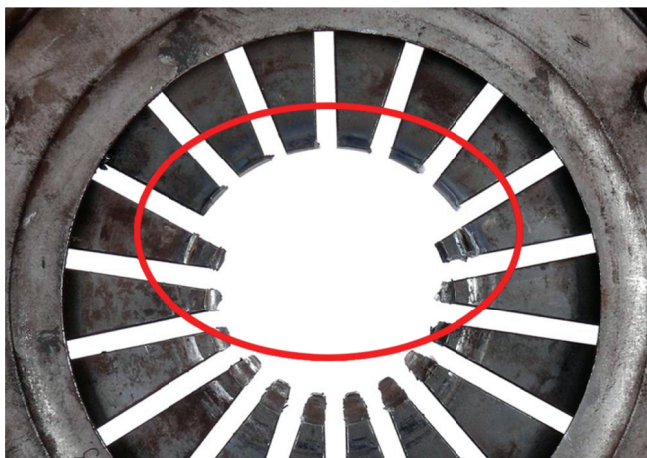
Obr. 1: Stisknutá spojka: Přebroušená membránová pružina
