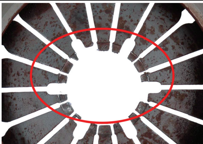
Obr. 3: Vysunutá spojka: Přebroušená membránová pružina
