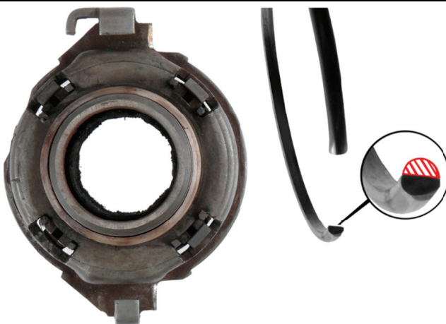
Obr. 4: Vypínací zařízení: Silně zploštělý pojistný kroužek
