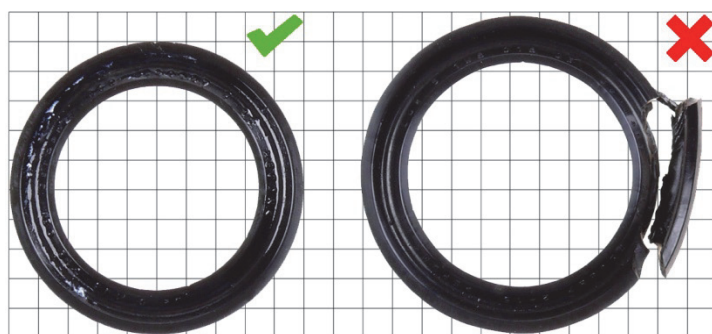
obr. 4: Nový těsnící kroužek s břitem (1)
