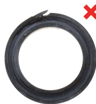
obr. 7: Těsnící kroužek s břitem (1) odštířený
