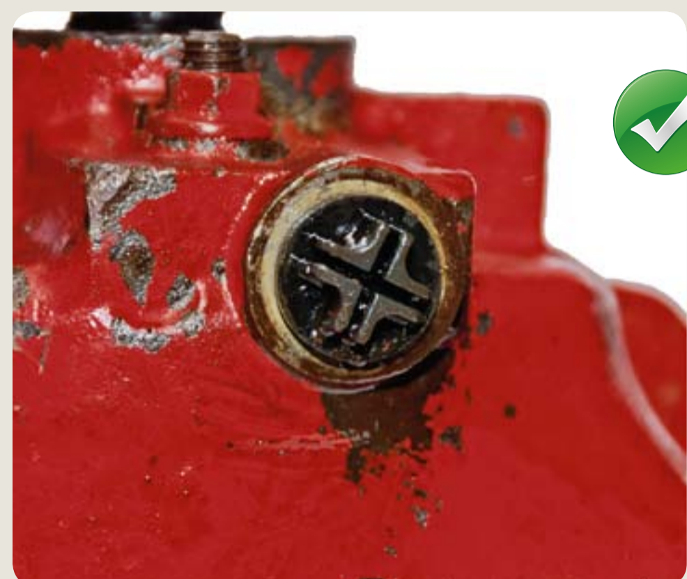
připojovací závit nepoškozen
