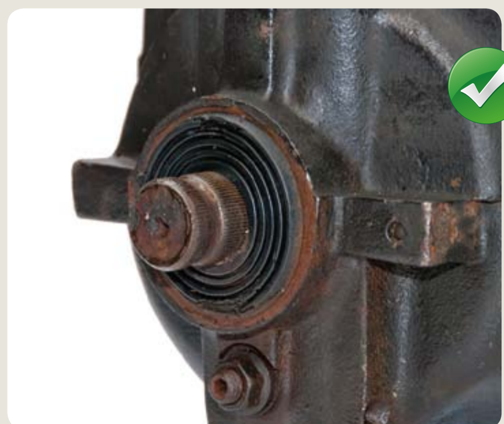
ozubení není poškozeno
