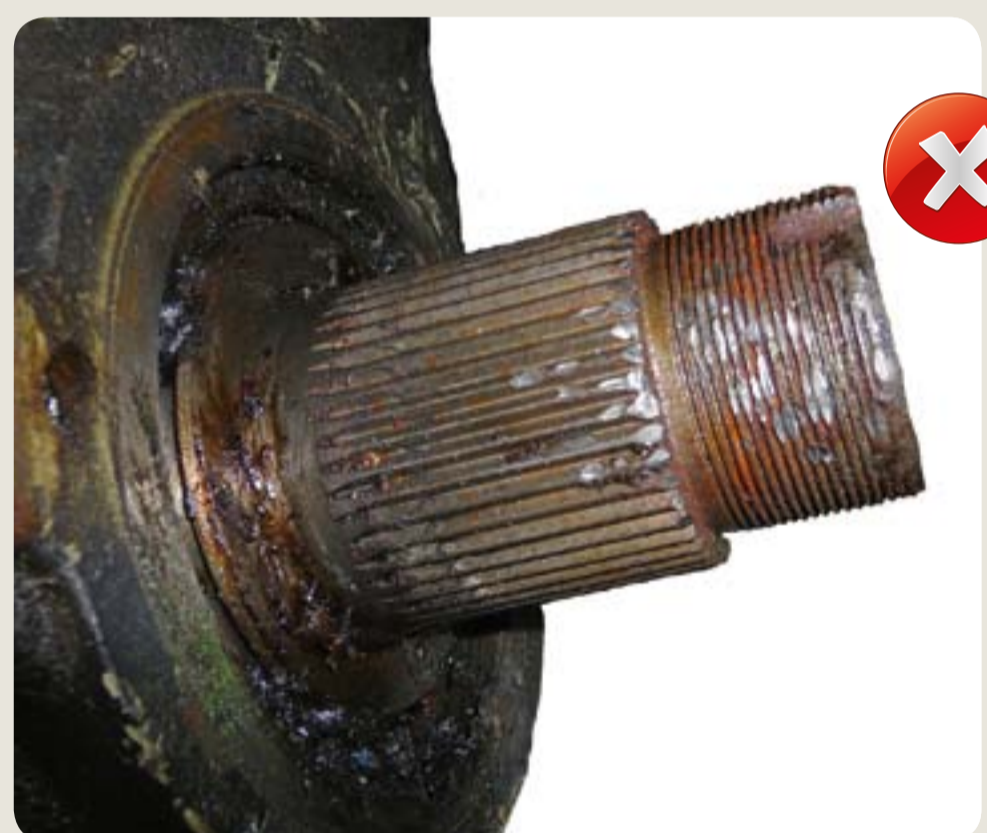
poškozené ozubení poškození vzniklá při demontáži
