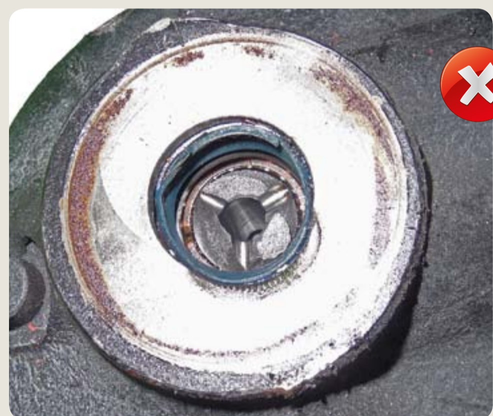
poškozený závit poškození vzniklá při demontáži
