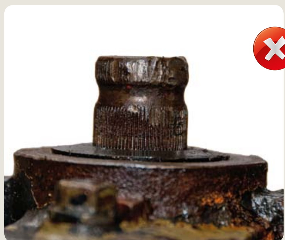
poškozené ozubení poškození vzniklá při demontáži
