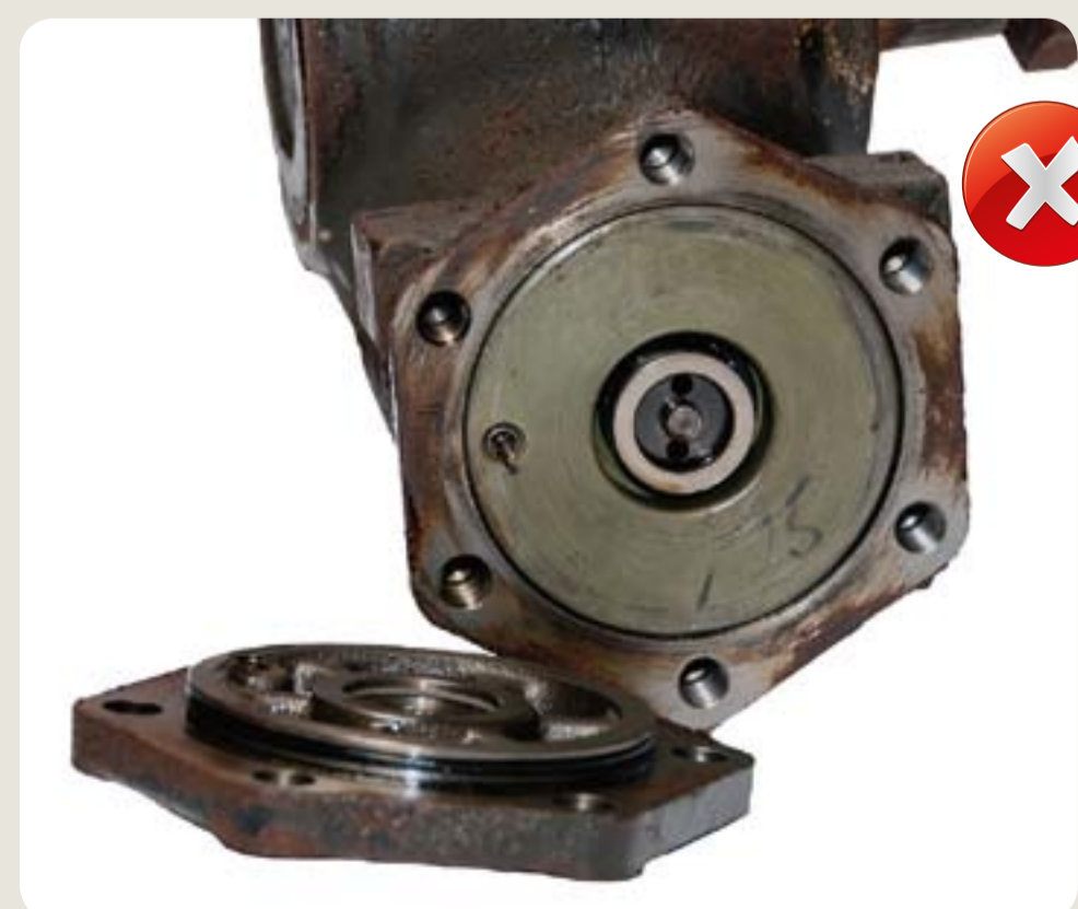
částečně demontováno / neúplné cizí opracování
